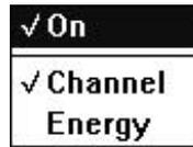
Mittels „Grid“ können Sie im Spektrenwiedergabefeld ein **Raster** im Koordinatensystem einschalten. Dieses Raster kann entweder nach **Kanälen** „Channel“ oder nach **Energie** „Energy“ ausgerichtet sein. Ob und welches Raster aktiv ist, ist am Häkchen zu erkennen.
