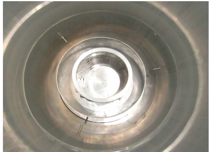
Abbildung 4: Inneres des Abschirmgehäuses mit Aluminium- und \mu -Metallzylinder.
