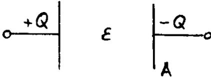
In einem gewöhnlichen Plattenkondensator liegen die Ladungen  $+Q$  und  $-Q$  auf Platten der Fläche  $A$  getrennt durch ein Medium mit der Dielektrizitätskonstante  $\epsilon$ .
