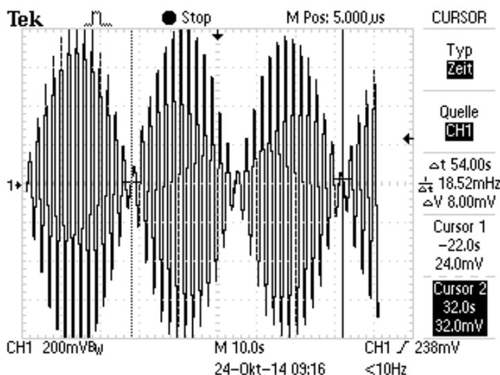
Mit der Cursorfunktion können Sie Zeiten ausmessen, z.B. die Zeit einer Schwebungsperiode. (Taste CURSOR rechts oben am Oszilloskop, Sie bewegen den Cursor mit dem Drehknopf oben rechts neben dem Display. Es gibt zwei Cursor, die Sie über die Tasten rechts unten neben dem Display umschalten.)
