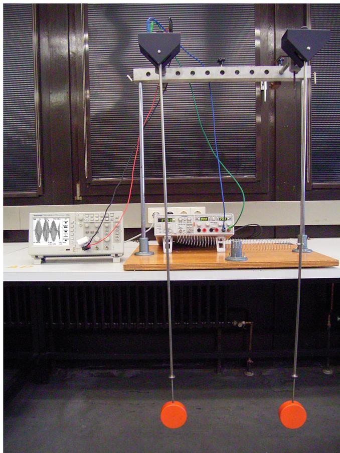
Zur Aufzeichnung der Schwingungen des linken Pendels verwenden wir ein Speicheroszilloskop, die Meßwerte (Oszilloskopbilder) können auch auf einen USB-Stick<sup>2</sup> gespeichert werden.
