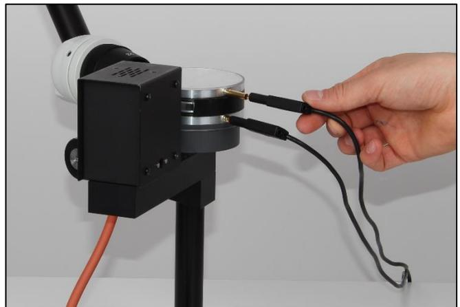
Fig. 3: Anschluss des Kondensators mit Schutzkontakt-Steckern.
