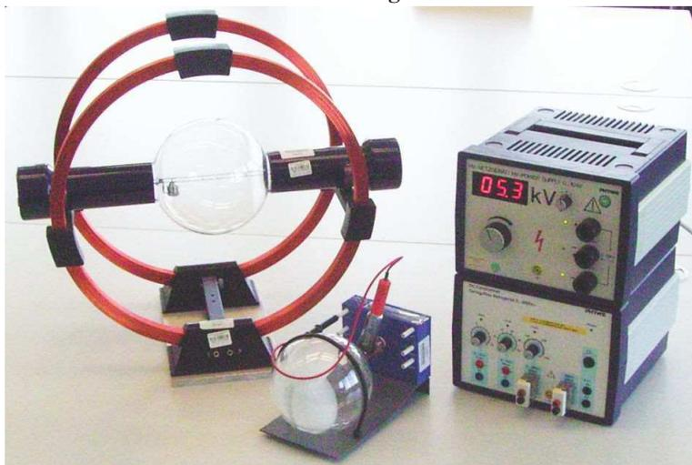
links Fadenstrahlrohr mit Helmholzspulenpaar, unten mittig Beugungsröhre, rechts die beiden Netzteile.
