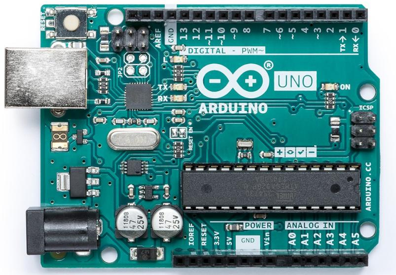
Das Arduino Uno ist ein Entwicklungsboard aus der Arduino-Familie und bestückt mit einem Microchip ATmega328P Mikrocontroller. Dieser Mikrocontroller bietet Ihnen insgesamt 32 kByte an Programmspeicher und 2 kByte Arbeitsspeicher. Über diverse Buchsenleisten sind einige I/O-Pins nach außen geführt. Darunter befinden sich 13 digitale Pins, die sich als Eingang und Ausgang konfigurieren lassen, sowie 6 analoge Eingänge.
