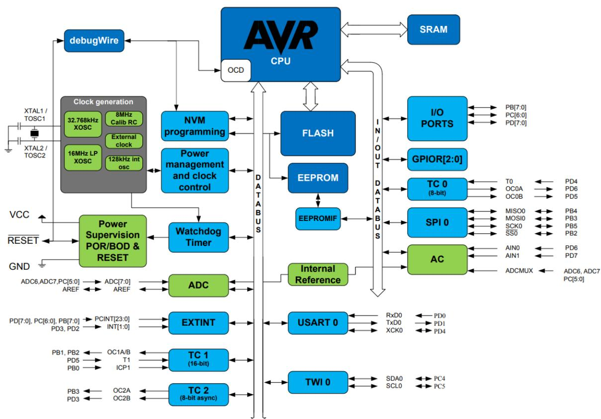
Zentraler Bestandteil eines Mikrocontrollers ist der Prozessor (CPU). Der Prozessor lädt Befehle und Daten aus dem (nicht-)flüchtigen Speicher (SRAM, FLASH) und führt diese aus. Der Prozessor ist dabei noch in weitere Einheiten unterteilt.
