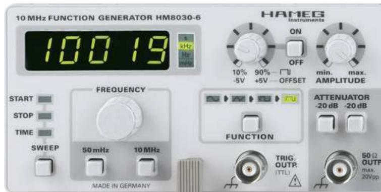
Sie verwenden als Kurvenform: Rechteckgenerator mit einstellbarem Impuls-Pausen-Verhältnis, das ist die mit der Anzeige ganz rechts (im Bild oben leuchtet diese grün). Sehen Sie sich das Signal mit dem Oszilloskop an. Stellen Sie eine Signalamplitude von 5 V ein. Drücken Sie den Schalter links neben dem Amplitudenknopf herein, dann können Sie mit dem Knopf links neben diesem Schalter auch das Impuls-Pausen-Verhältnis verändern.
