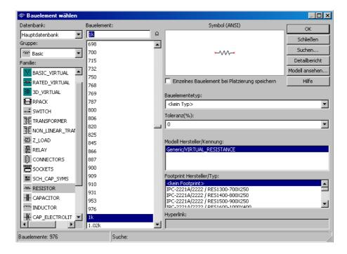
Links oben können Sie unter *Gruppe* die Bauteilgruppe (z.B. Basic = Standard oder aber Dioden, Transistor) wählen.
