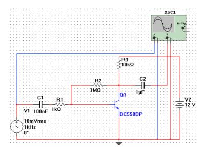
Wie groß ist der Verstärkungsfaktor? Wie ändert er sich, wenn Sie R2 oder R3 verändern? Welchen Sinn könnte R1 haben? (Wie sieht die Eingangskennlinie aus? Sie wollen eine Spannung verstärken, aber der Transistor verstärkt Ströme!)
