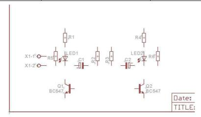
Wenn Sie mit der Funktion SMASH auf die Bauteile klicken, löst sich der Bauteilname vom Package, d.h. Sie können den Text (mit MOVE) einzeln anklicken, drehen und verschieben, damit es besser lesbar ist.
