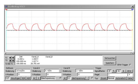
Probieren Sie aus, wie sich das Bild verändert, wenn Sie andere Skalierungen (Zeitbasis oder Kanal A) einstellen. Sie finden am virtuellen Oszilloskop die gleichen Bedienungselemente vor wie bei einem realen Gerät.
