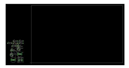
Reduzieren Sie die Größe der Leiterplatte auf etwa 37 mm Breite und 23 mm Höhe (1450 mil  $\times$  900 mil oder 1,45 inch  $\times$  0,9 inch). Dazu verschieben Sie mit der Move-Funktion die rechte und obere weiße Dimensionslinie. Links oben bei der Menüleiste sehen Sie die aktuellen Cursor-Koordinaten.
