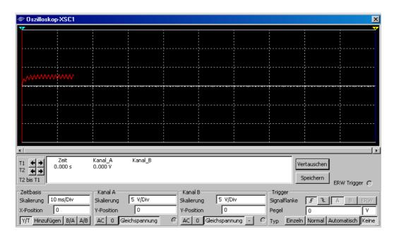
Offenbar ist die Frequenz des Rechteckgenerators zu hoch, daher wollen wir sie ändern. Doppelklicken Sie auf das Generatorsymbol. Es erscheint ein Menü, in dessen Registerkarte *Wert* Sie Frequenz, Tastverhältnis und Spannung ändern können. Geben Sie als neue Frequenz 100 Hz ein.
