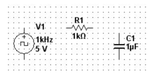
Der Schaltplan ist so noch nicht fertig, denn es fehlen ja die Verbindungen.
