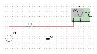
Verwenden Sie einen Rechteckgenerator und stellen Sie eine geeignete Frequenz ein. Simulieren Sie das Zeitverhalten des Ausgangssignals (y(t)-Kurve).
