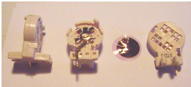
Feuchtesensor — links: zusammengebaut, rechts: die zwei Kontaktseiten, dazwischen das Folienscheibchen
